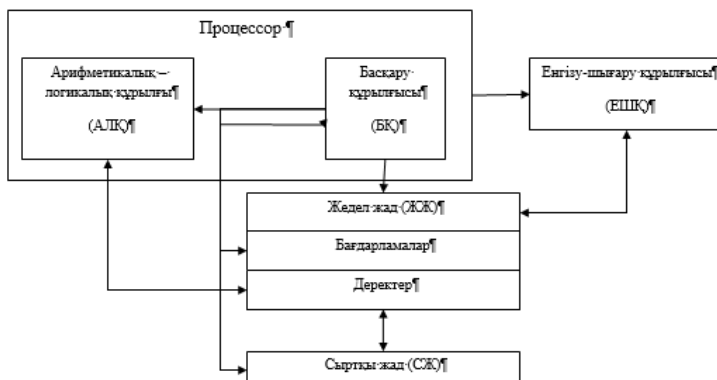
Сурет 1. Фон Нейманның принциптеріне сәйкес құрастырылған компьютердің классикалық блок-схемасы суретте көрсетілген.
